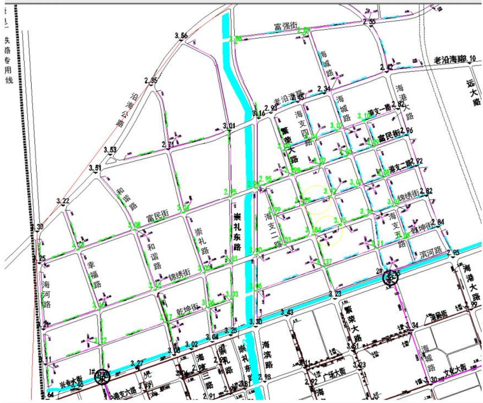
附图 2-2 污水工程总平面图
